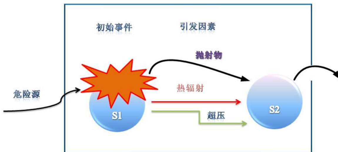
图3.6.4-1多米诺效应系统图
