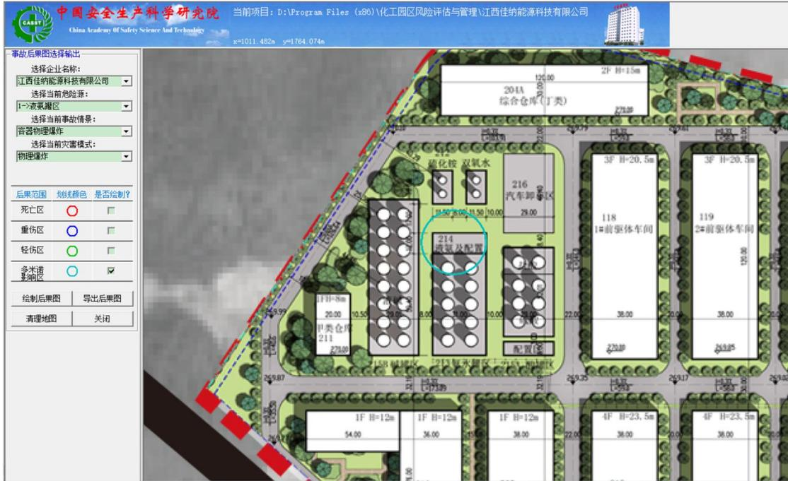
F 图 4.5-3 液氨罐区多米诺影响区域图
